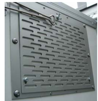
Mexus (Aufpreis), Luxus (Serie): Lüftungsschieber innen (links offen, rechts geschlossen)
